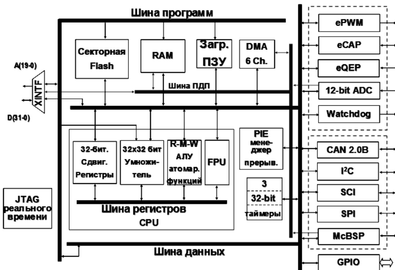
Рис. 3. Блок-схема контроллера TMS320F2833x
